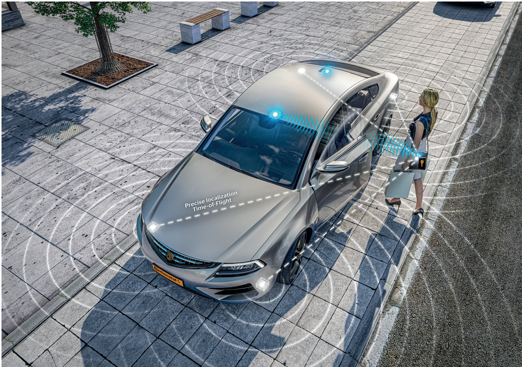
Bild 2: Die Kombination aus BLE und UWB in der neuen Zugangslösung ist sowohl sicher als auch komfortabel und ermöglicht, das Auto zu öffnen und zu starten, ohne das Smartphone aus der Tasche nehmen zu müssen.
